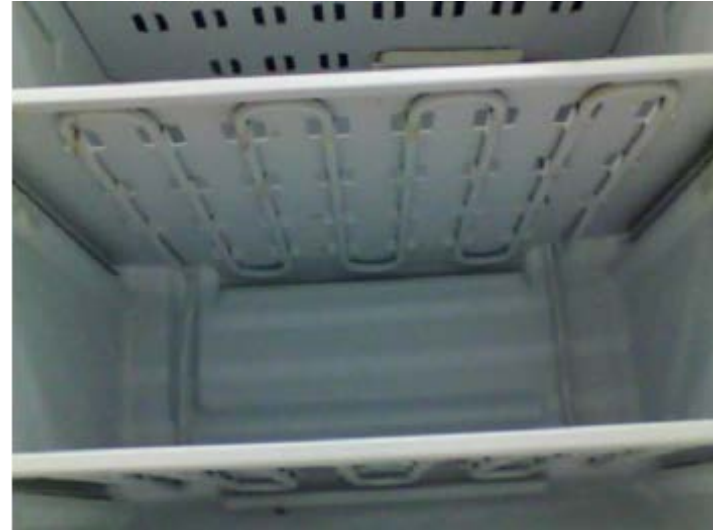
Нехватка хладагента в испарителе бытового холодильника
