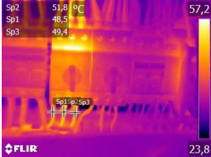
Проверка равномерности распределения нагрузки по фазам
