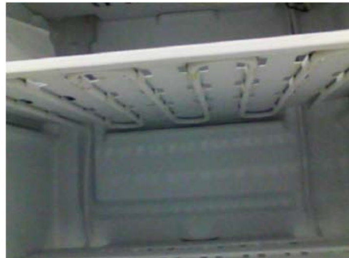
Правильно заполненный испаритель бытового холодильника
