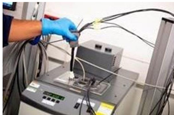
Рис.12. Метрологічна перевірка температурного самописця зовнішнім зондом ©Cemafruid
