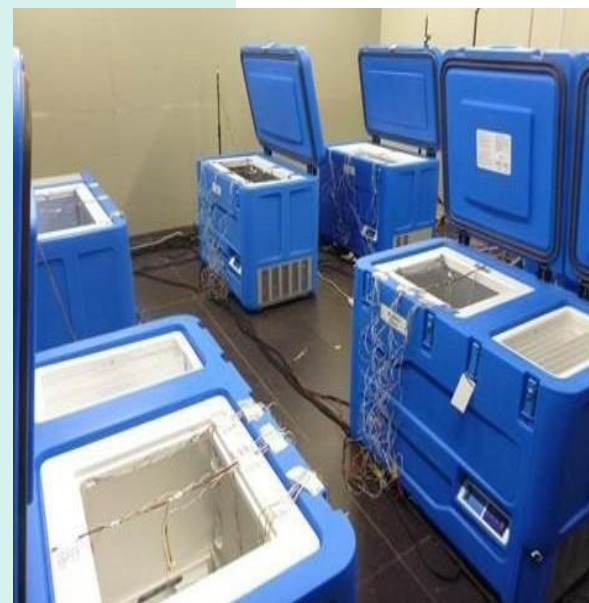
Рис. 11. Тестування холодильників для вакцин за програмою контролю якості ВООЗ ©Cemafruid
