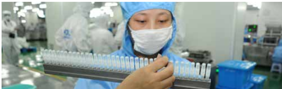
ВИЗУАЛЬНЫЙ КОНТРОЛЬ ЧИСТОТЫ МЕДИЦИНСКИХ ИНСТРУМЕНТОВ ПОСЛЕ ИХ ОЧИСТКИ С ПОМОЩЬЮ РАСТВОРИТЕЛЯ, НЕ СОДЕРЖАЩЕГО ОРВ. ФОТОГРАФИЯ ПРЕДОСТАВЛЕНА: УВЭС МООС, КИТАЙ.
