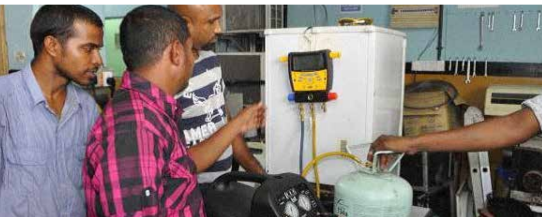
РЕКУПЕРАЦИЯ ХЛАДАГЕНТА, ИСПОЛЬЗУЕМОГО В СЕКТОРЕ РЫБОЛОВСТВА. ФОТОГРАФИЯ ПРЕДОСТАВЛЕНА: МТИ И НАЦИОНАЛЬНЫЙ ОРГАН ПО ОЗОНУ, МАЛЬДИВСКИЕ ОСТРОВА.
