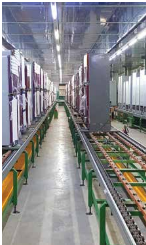
ЛИНИЯ ПРОБНОЙ ЭКСПЛУАТАЦИИ КОМПРЕССОРА R600A ДЛЯ ХОЛОДИЛЬНИКОВ В КОМПАНИИ «УОЛТОН». ФОТОГРАФИЯ ПРЕДСТАВЛЕНА: АШРАФУЛ АМБИА, ИСПОЛНИТЕЛЬНЫЙ ДИРЕКТОР КОМПАНИИ «УОЛТОН».
