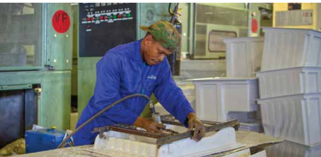
ЧИСТОВАЯ ОБРАБОТКА ПАНЕЛЕЙ ДВЕРЦЫ ХОЛОДИЛЬНИКА, СФОРМИРОВАННЫХ С ПРИМЕНЕНИЕМ ЦИКЛОПЕНТАНА В КАЧЕСТВЕ ПЕНООБРАЗОВАТЕЛЯ, НА ЗАВОДЕ КОМПАНИИ «ПАЛФРИДЖ». ФОТОГРАФИЯ ПРЕДОСТАВЛЕНА: КОМПАНИЯ «ПАЛФРИДЖ».
