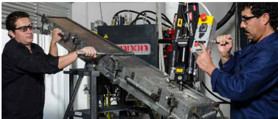
ИСПЫТАНИЯ ПАНЕЛИ ИЗ ПЕНОМАТЕРИАЛА В КОМПАНИИ «ЭСПУМЛАТЕКС» С ИСПОЛЬЗОВАНИЕМ ЛИТЕЙНОЙ ФОРМЫ БРЕТТА. ФОТОГРАФИЯ ПРЕДОСТАВЛЕНА: ЭСТЕБАН ГАРСИА, «ЭСПУМЛАТЕКС».
